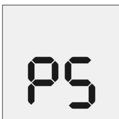
Le flacon pulvérisateur doit être actionné 5 fois (amorçage) avant de pouvoir être utilisé (voir rubrique « Préparation du flacon pulvérisateur Instanyl »). L'écran affiche un compte à rebours après chaque actionnement (P5, P4, P3, P2 et P1). Le flacon est prêt à l'emploi lorsque l'écran affiche le nombre de doses (20, 30 ou 40 doses).
