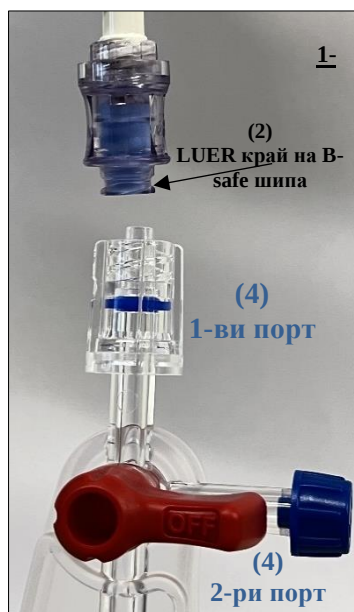
Фиг. 12 Първият вентил в положение ON: дръжката е подравнена с B-safe шина (2) и колектора на спирателното кранче (4), което позволява преминаването на флуида.
