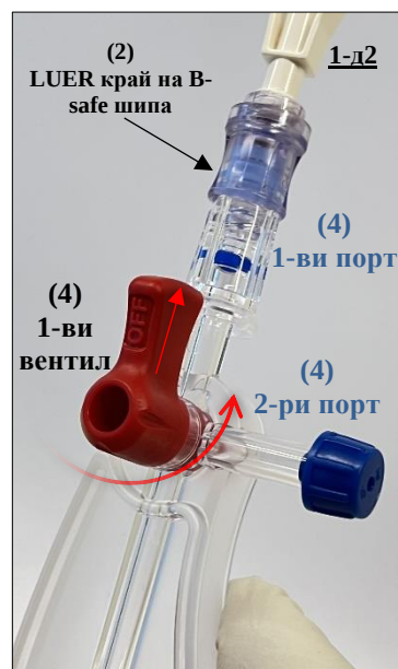
Фиг. 13 Завъртане на вентила на 90° по часовниковата стрелка, за да се достигне позиция OFF.: дръжката е перпендикулярна, затваряйки връзката между шина (2) и колектора (4).
