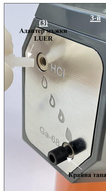
Фиг. 19 Прикрепване на мъжкия LUER адаптер (3) към HCl порта на радионуклидният генератор.
