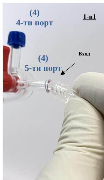
Фиг. 9 Позициониране на мъжкия LUER край на входящата удължителна тръбичка (5) преди свързване към петия порт.
