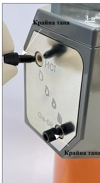
Фиг. 18 Капачка на HCl порта на радионуклидният генератор, преди отстраняване.
