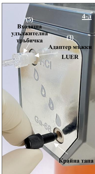
Фиг. 21 Отстраняване на капачката на Ga-68 порта на радионуклидния генератор.
