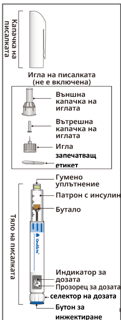
Фигура 1 Схема на писалката
