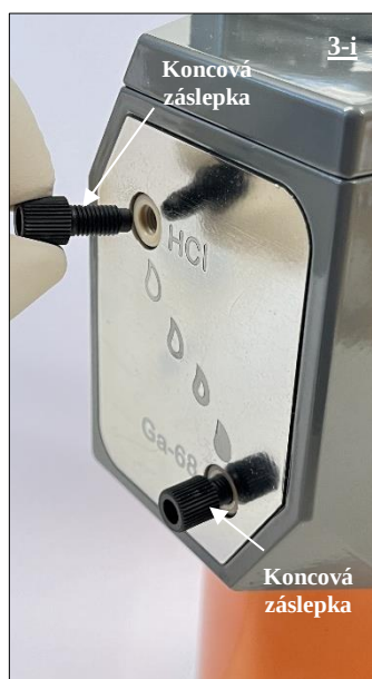
Obr. 18 Koncová zálepka zakrývající HCl port radionuklidového generátoru před odstraněním.
