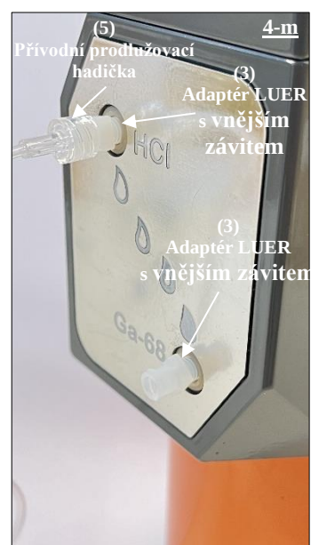
Obr. 22 Připojení druhého adaptéru LUER s vnějším závitem (3) k portu Ga-68.
