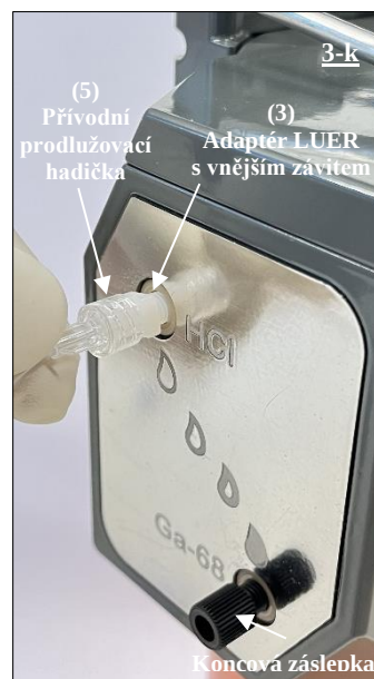
Obr. 20 Připojení konce LUER s vnitřním závitem přívodní prodlužovací hadičky (5) k HCl portu s připojeným adaptérem.
