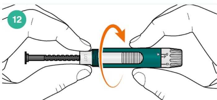
Znovu zatáhněte vnitřní píst. Držte při tom šedý kroužek pro zatažení pístu na těle pera mezi palcem a dalším prstem (obr. 12). Otáčejte tělem pera, dokud nebude vnitřní píst plně zatažen (obr. 2). Poté se vraťte ke kroku 3 a vložte do pera další zásobní vložku.
