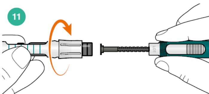
Pokud chcete zásobní vložku vyměnit, ujistěte se, že je z pera odstraněna injekční jehla. Odšroubujte držák zásobní vložky z těla pera a zásobní vložku vyjměte (obr. 11).
