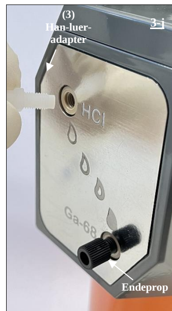
Fig. 19 Han-luer-adapteren (3) sættes i radionuklidgeneratorens HCl-åbning.
