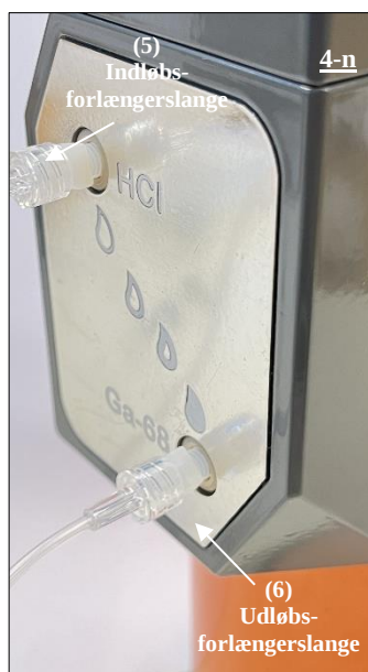
Fig. 23 Tilslutning af indløbsenden (hun-luer-enden) af udløbsforlængerslangen (6) til Ga-68-åbningen via adapteren.
