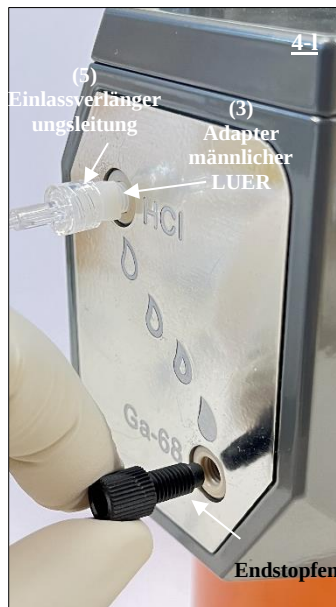
Abb. 21 Entfernen des Endstopfens vom Ga-68-Port des Radionuklidgenerators.
