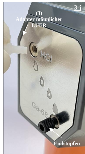
Abb. 19 Anbringen des männlichen LUER-Adapters (3) am HCl-Port des Radionuklidgenerators.
