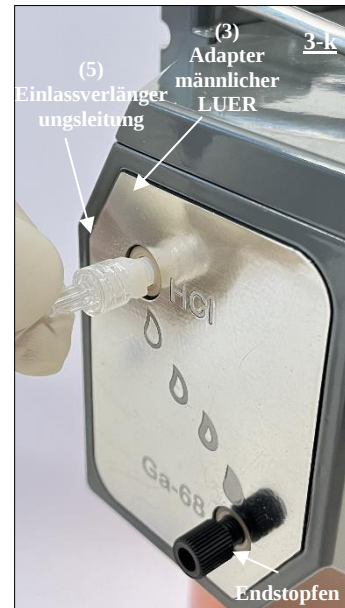
Abb. 20 Anschluss des weiblichen LUER-Endes der Einlassverlängerungsleitung (5) an den mit dem Adapter verbundenen HCl-Port
