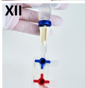
**4. Verbinden der Einlassleitung mit dem Anschluss des Radionuklidgenerators:**
