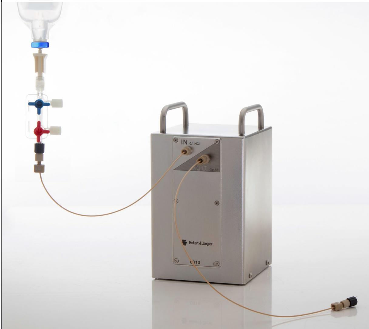
Bitte beachten: Der Radionuklidgenerator ist so konstruiert, dass er sich nicht von selbst entleert, wenn keine Leitungen am Einlass- und Auslassport angeschlossen sind; es wird aber davon abgeraten, die Ports geöffnet zu lassen.
