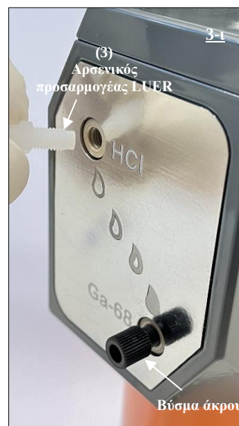
Εικ. 19 Προσάρτηση του αρσενικού προσαρμογέα LUER (3) στη θύρα HCl της γεννήτριας ραδιονουκλιδίου.
