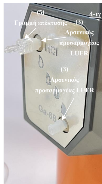
Εικ. 22 Προσάρτηση του δεύτερου αρσενικού προσαρμογέα LUER (3) στη θύρα Ga-68 της γεννήτριας ραδιονουκλιδίου.
