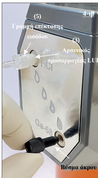
Εικ. 21 Αφαίρεση του βύσματος άκρου από τη θύρα Ga-68 της γεννήτριας ραδιονουκλιδίου.
