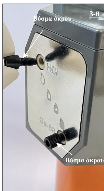
Εικ. 18 Βύσμα άκρου που καλύπτει τη θύρα HCl της γεννήτριας ραδιονουκλιδίου, προτού αφαιρεθεί.
