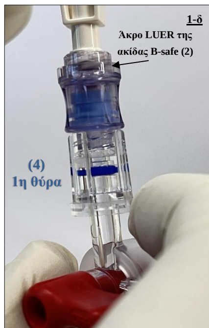
Εικ. 11 Στη συνέχεια, συνδέστε το άκρο LUER της ακίδας B-safe (2) στην πρώτη θύρα της πολλαπλής με στρόφιγγα (4) μετά την αφαίρεση του βύσματος.
