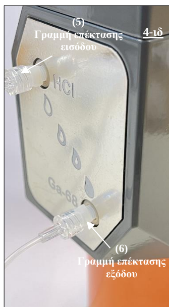
Εικ. 23 Σύνδεση του άκρου εισόδου (θηλυκού άκρου LUER) της γραμμής επέκτασης εξόδου (6) στη θύρα Ga-68, μέσω του προσαρμογέα.
