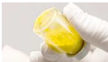
Polvere non passata in sospensione: grumi visibili
