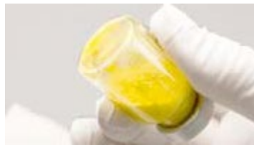
Polvere non passata in sospensione: grumi visibili
