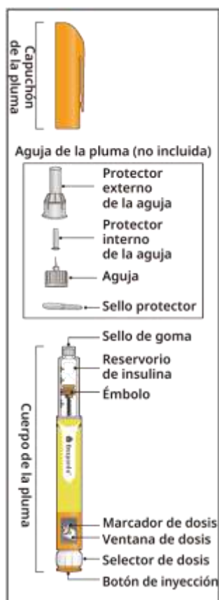
Figura A Descripción general de la pluma precargada Dazpada (VitaClick) y las agujas (ejemplo)
