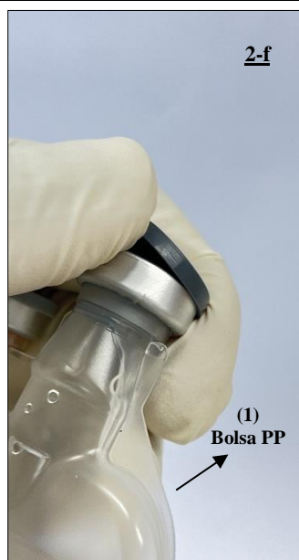
Fig. 14 Retirada del tapón de la bolsa PP que contiene los 220 ml de solución estéril de ácido clorhídrico a una concentración de 0,1 mol/l (1).
