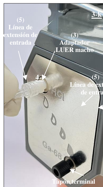
Fig. 20 Conexión del extremo hembra LUER de la línea de extensión de entrada (5) al puerto de HCl acoplada al adaptador
