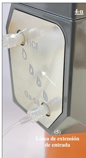
Fig. 23 Conexión del extremo LUER hembra de la línea de extensión de salida (6) al puerto de Ga-68 mediante el adaptador acoplado.
