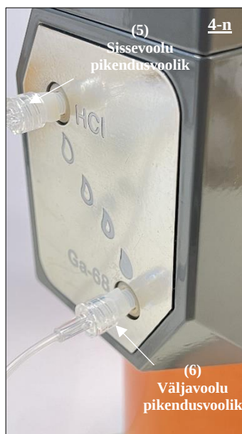
Joonis 23. Väljavoolu pikendusvooliku (6) LUER-luku pistikotsa ühendamine adapteri kaudu Ga-68 pordiga.
