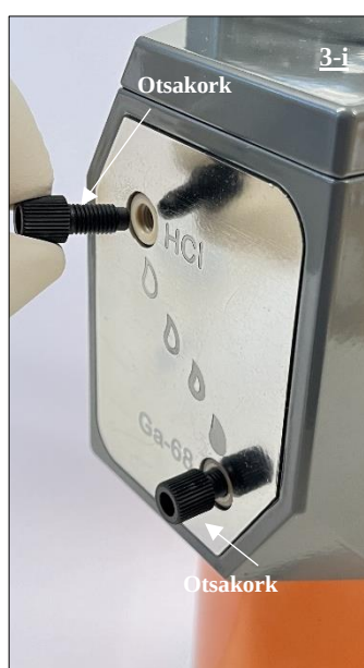
Joonis 18. Radionukliidgeneraatori HCl-porti kattev otsakork enne eemaldamist.
