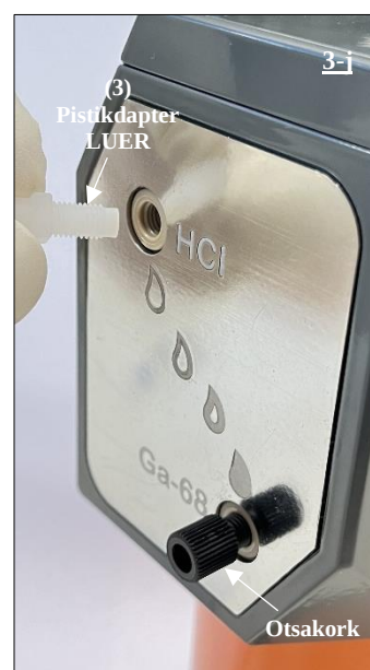
Joonis 19. LUER-luku pistikadapteri (3) kinnitamine radionukliidgeneraatori HCl-pordiga.
