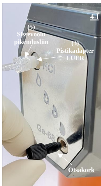
Joonis 21. Otsakorgi eemaldamine radionukliidgeneraatori Ga-68 pordist.
