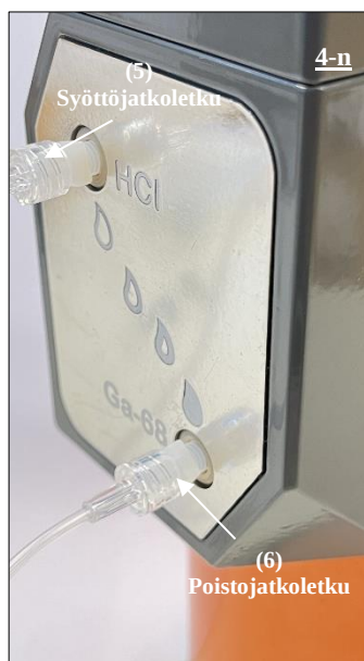
Kuva 23. Poistoletkun (6) syöttöpään (naaras-LUER-pään) liittäminen liittimellä Ga-68-porttiin.
