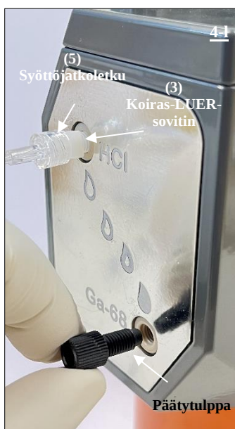
Kuva 21. Tulpan irrottaminen radionuklidigeneraattorin Ga-68-portista.
