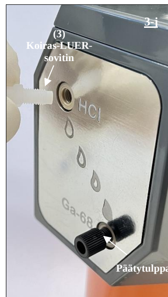
Kuva 19. Koiras-LUER-liittimen (3) liittäminen radionuklidigeneraattorin HCl-porttiin.
