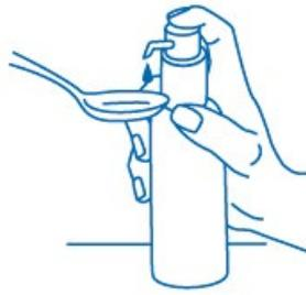
La tête de la pompe doseuse peut alors être relâchée et la pompe est prête pour la pression suivante.
