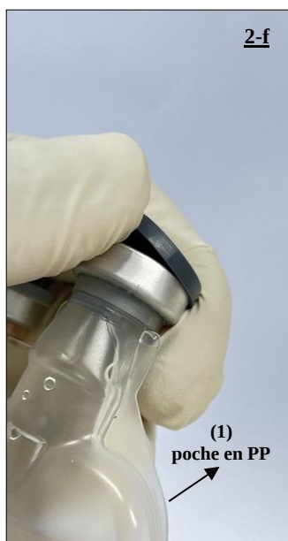
Fig. 14 Retrait de la coiffe de la poche en PP, contenant les 220 mL de solution stérile d'acide chlorhydrique 0,1 mol/L (1)
