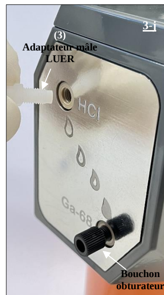
Fig. 19 Fixation de l'adaptateur mâle LUER (3) au canal HCl du générateur radiopharmaceutique
