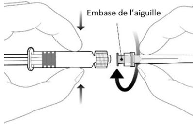
Pour fixer l'aiguille, connecter l'embase de l'aiguille sur l'adaptateur Luer Lock et tourner d'un quart de tour dans le sens des aiguilles d'une montre jusqu'à sentir un blocage.
