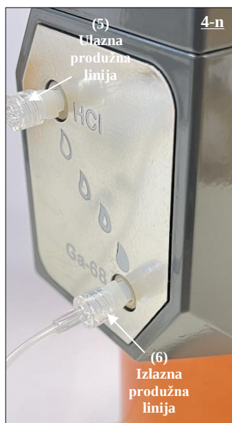
Sl. 23 Spajanje ulaznog kraja (ženski LUER vrh) izlazne produžne linije (6) na Ga-68 otvor putem priključka.
