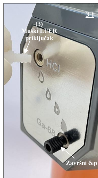
Sl. 19 Spajanje muškog LUER priključka (3) na HCl otvor generatora radionuklida.
