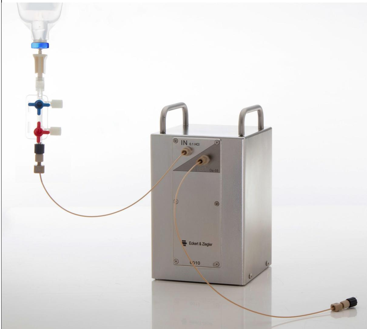
Napomena: Generator radionuklida je dizajniran na način da je spriječeno istjecanje kada nema spojenih linija na ulaznom i izlaznom otvoru, ali ne preporučuje se ostaviti otvore otvorenim u bilo kojem trenutku.
