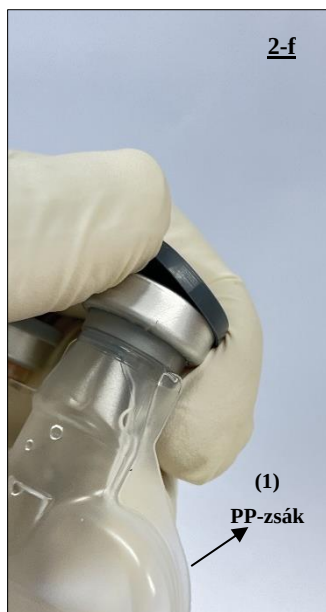
14. ábra A 220 ml, steril 0,1 mol/l sósavoldatot (1) tartalmazó PP-zsák kupakjának eltávolítása.
