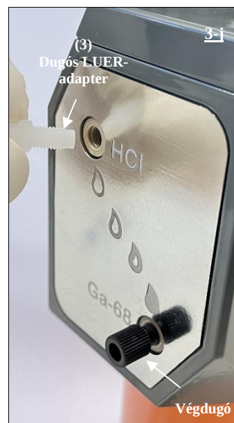
19. ábra A dugós LUER-adapter (3) csatlakoztatása a radioaktívizotóp-generátor HCl-portjához.
