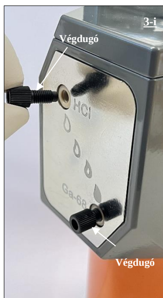
18. ábra A radioaktívizotóp-generátor HCl-portját fedő végdugó az eltávolítás előtt.
