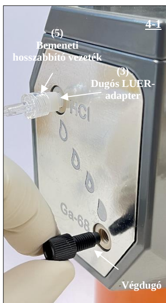
21. ábra A végdugó eltávolítása a radioaktívizotóp-generátor Ga-68-portjáról.
