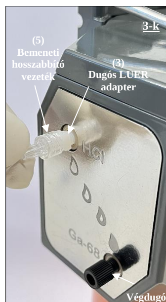
20. ábra A bemeneti hosszabbító vezeték (5) LUER-aljzat-végének csatlakoztatása az adapterrel felszerelt HCl-porthoz
