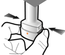
Skref 2a: Gatið hylkið einu sinni Haldið innöndunartækinu uppréttu. Gatið hylkið með því að þrýsta þétt á báða hliðarhnappana samtímis. Það á að heyrast smellur þegar hylkið gatast. Gatið hylkið einungis einu sinni.
