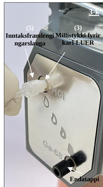
Mynd 20 Tening kvenkyns LUER-endans á inntaksframlengingarslöngunni (5) við HCl-tengið sem er fest við millistykkið
