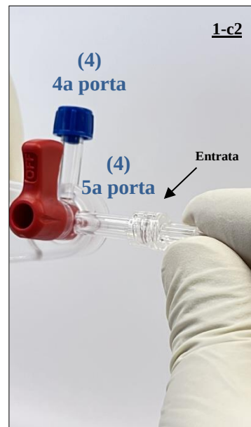
Fig. 10 Completamento del collegamento LUER tra la linea di estensione di entrata (5) e la quinta porta del connettore con rubinetti (4).
