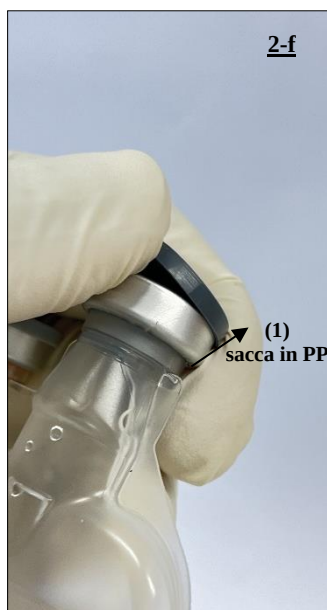
Fig. 14 Rimozione del tappo dalla sacca in PP contenente i 220 mL di soluzione di acido cloridrico sterile 0,1 mol/L (1).
