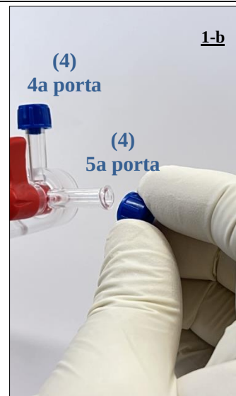
Fig. 8 Rimozione del tappo protettivo dalla quinta porta del connettore con rubinetti (4).
