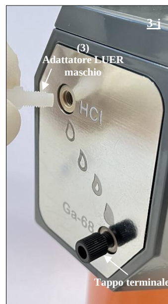
Fig. 19 Collegamento dell'adattatore LUER maschio (3) alla porta HCl del generatore di radionuclidi.
