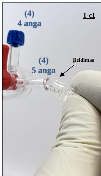
9 pav. Nustatoma įleidimo ilginamosios linijos (5) LUER jungties galo padėtis prieš prijungiant prie penktosios angos.
