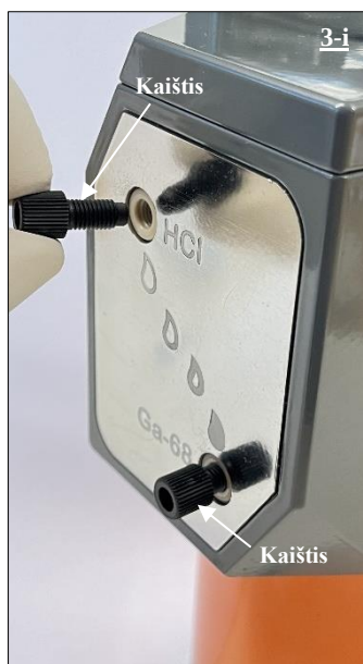
18 pav. Kaištis, dengiantis radionuklidų generatoriaus HCl prievadą prieš išėmimą.
