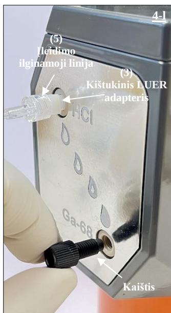
21 pav. Kaištis ištraukiamas iš radionuklidų generatoriaus Ga-68 prievado.
