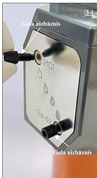
18. att. Gala aizbāznis, kas nosedz radionuklīdu ģeneratora HCl pieslēgvietu, pirms noņemšanas.
