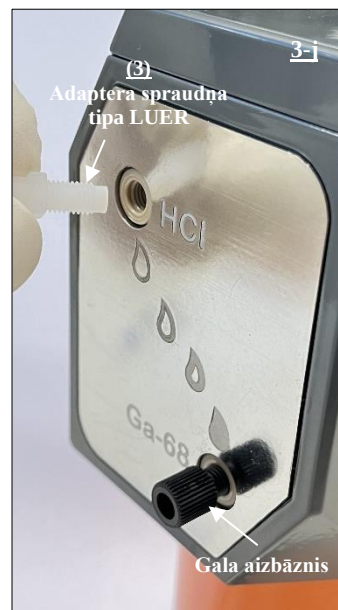
19. att. Spraudņa tipa LUER adaptera (3) pievienošana radionuklīdu ģeneratora HCl pieslēgvietai.
