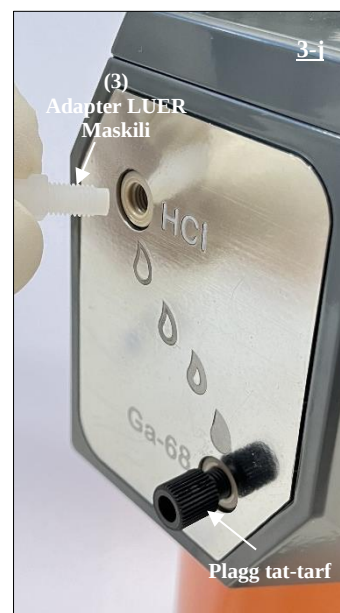
Fig. 19 It-twaħħil tal-adapter LUER maskili (3) mal-port HCl tal-ġeneratur ta' radjunuklidi.
