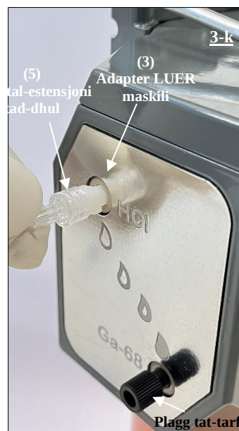
Fig. 20 Il-konnessjoni tat-tarf LUER femminili tal-pajp tal-estensjoni tad-dhul (5) mal-port HCl imwahhal b'adapter
