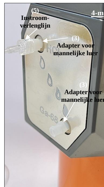
Fig. 22. De tweede adapter voor mannelijke luer (3) aansluiten op de Ga-68-poort.
