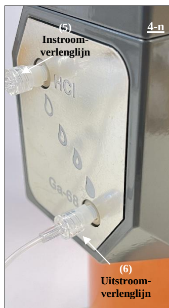
Fig. 23. Het instroom-uiteinde (vrouwelijke luer-uiteinde) van de uitstroom-verlenglijn (6) met de adapter aansluiten op de Ga-68-poort.
