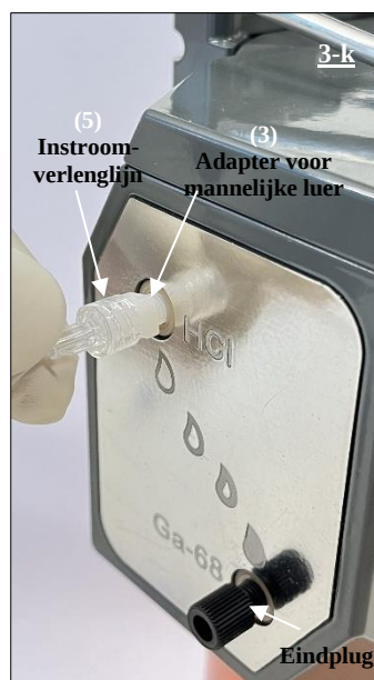
Fig. 20. Aansluiten van het vrouwelijke luer-uiteinde van de instroom-verlenglijn (5) op de aan de adapter verbonden HCl-poort
