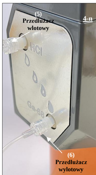
Rys. 23 Podłączanie końca wlotowego (żeńskiej końcówki LUER) przedłużacza wylotowego (6) do portu Ga-68 za pomocą łącznika.
