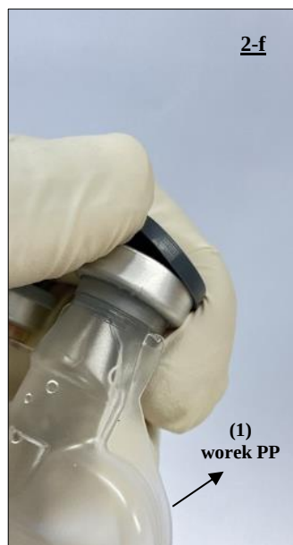
Rys. 14 Zdejmowanie nasadki z worka PP zawierającej 220 ml jałowego roztworu kwasu solnego 0,1 mol/l (1).
