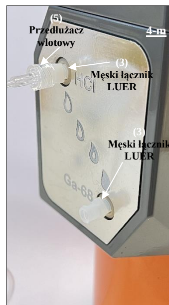
Rys. 22 Podłączanie drugiego męskiego łącznika LUER (3) do portu Ga-68.
