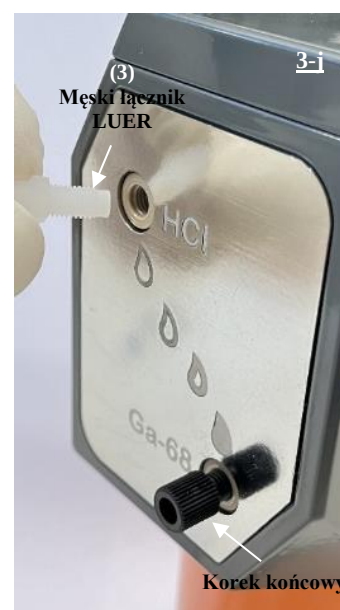
Rys. 19 Podłączanie męskiego łącznika LUER (3) do portu HCl generatora radionuklidu.
