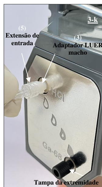
Fig. 20 Ligar a extremidade LUER fêmea da linha de extensão de entrada (5) à porta HCl acoplada no adaptador
