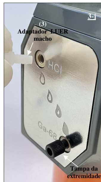
Fig. 19 Ligar o adaptador LUER macho (3) à porta HCl do gerador de radionuclídeos.
