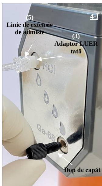
Fig. 21 Scoaterea dopului din portul Ga-68 al generatorului de radionuclizi.
