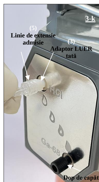
Fig. 20 Conectarea capătului LUER mamă al liniei de extensie de admisie (5) la portul HCl atașat la adaptor
