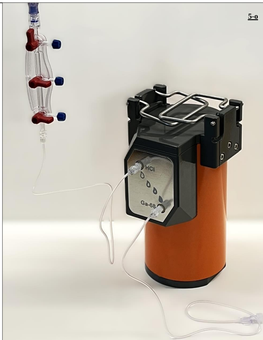
Fig. 24 Configurația finală asamblată a generatorului de radionuclizi cu toate accesoriile conectate.
