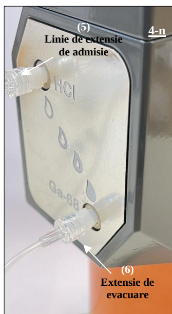
Fig. 23 Conectarea capătului de admisie (capăt LUER mamă) al liniei de extensie de evacuare (6) la portul Ga-68 prin intermediul adaptorului.
