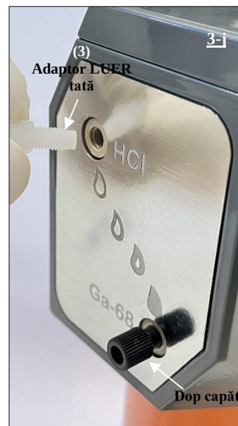
Fig. 19 Atașarea adaptorului LUER tată (3) la portul HCl al generatorului de radionuclizi.
