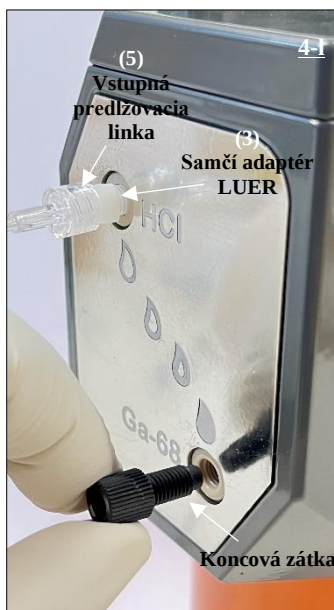
Obr. 21: Odstránenie koncovkej zátky z portu Ga-68 rádionuklidového generátora.
