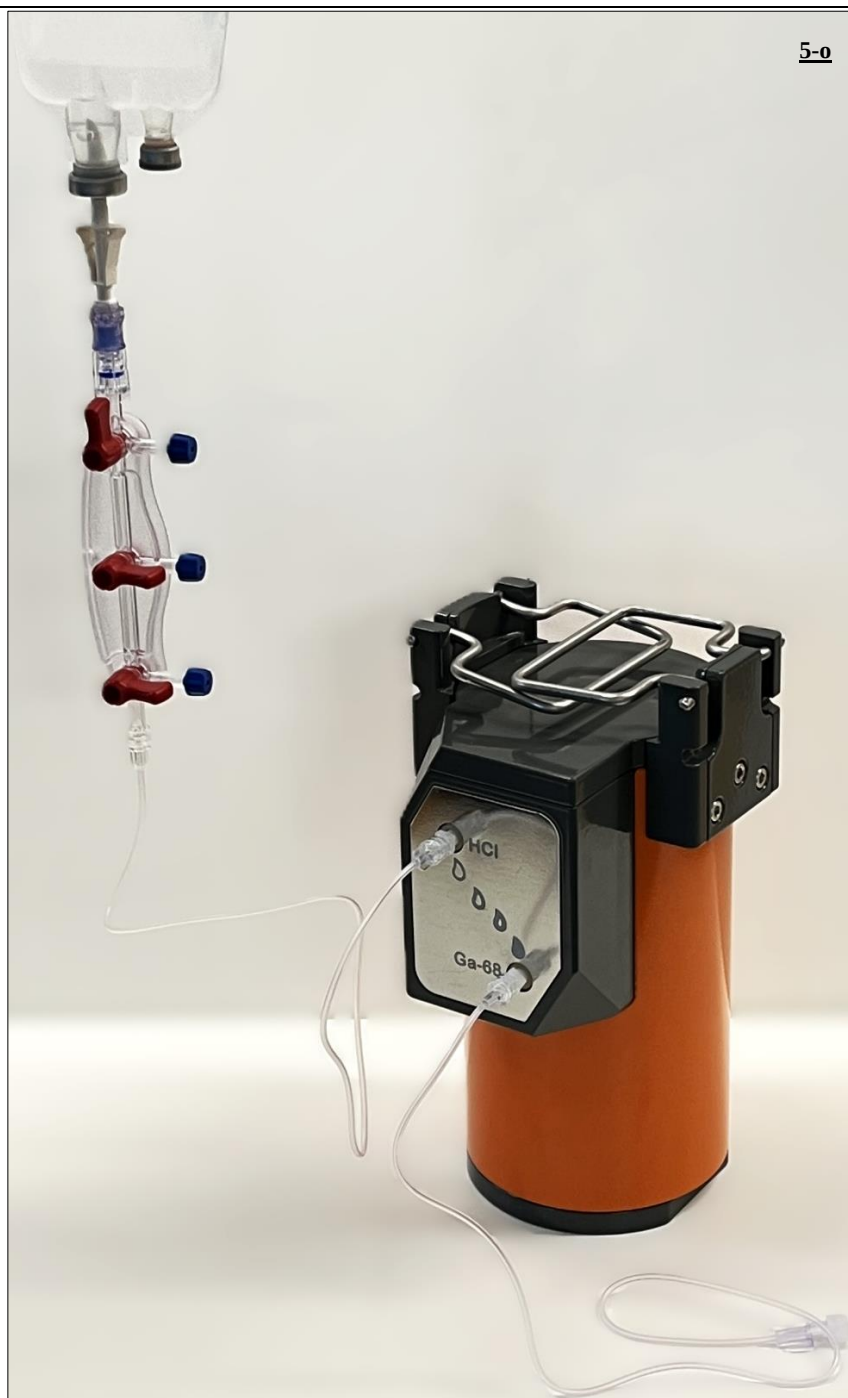
Obr. 24: Konečná konfigurácia zostavy rádionuklidového generátora so všetkým pripojeným príslušenstvom.
