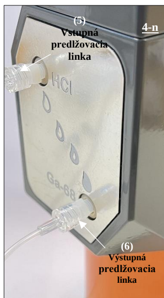
Obr. 23: Pripojenie vstupného konca výstupnej predlžovacej linky (6) (koniec so samičou spojkou LUER) k portu Ga-68 pomocou adaptéra.
