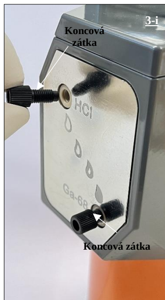
Obr. 18: Koncová zátka zakrývajúca port HCl rádionuklidového generátora pred odstránením.
