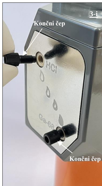
Sl. 18 Končni čep, ki pokriva odprtino HCl radionuklidnega generatorja pred odstranitvijo.
