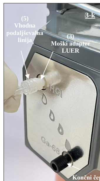
Sl. 20 Konec z ženskim priključkom LUER priključite na vhodno podaljševalno linijo (5) na odprtino HCl, priključeno z adapterjem
