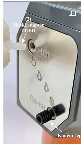
Sl. 19 Moški adapter LUER (3) pritrdite na odprtino HCl na radionuklidnem generatorju.
