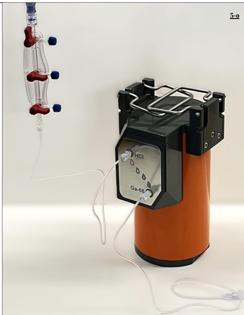
Sl. 24 Končna sestavljena konfiguracija radionuklidnega generatorja z vsemi priključenimi dodatki.
