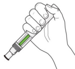
Slika J: Preverite zeleni kazalnik
