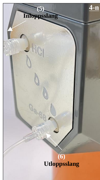
Fig. 23 Anslut inloppsänden (hon-LUER-änden) av utloppsfrlängningsledningen (6) till Ga-68-porten via adaptern.
