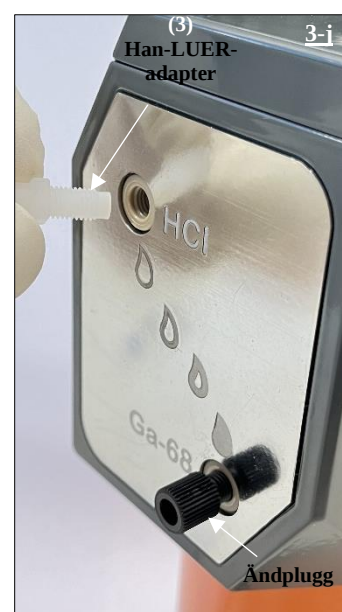
Fig. 19 Anslut han-LUER-adaptern (3) till HCl-porten på radionuklidgeneratoren.
