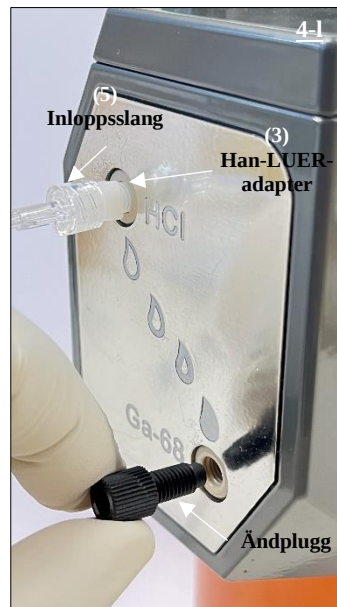
Fig. 21 Ta bort ändpluggen från Ga-68-porten på radionuklidgeneratoren.
