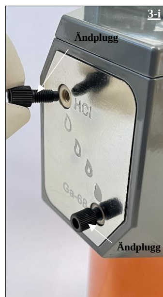
Fig. 18 Ändpluggen täcker HCl-porten på radionuklidgeneratoren innan pluggen tas bort.
