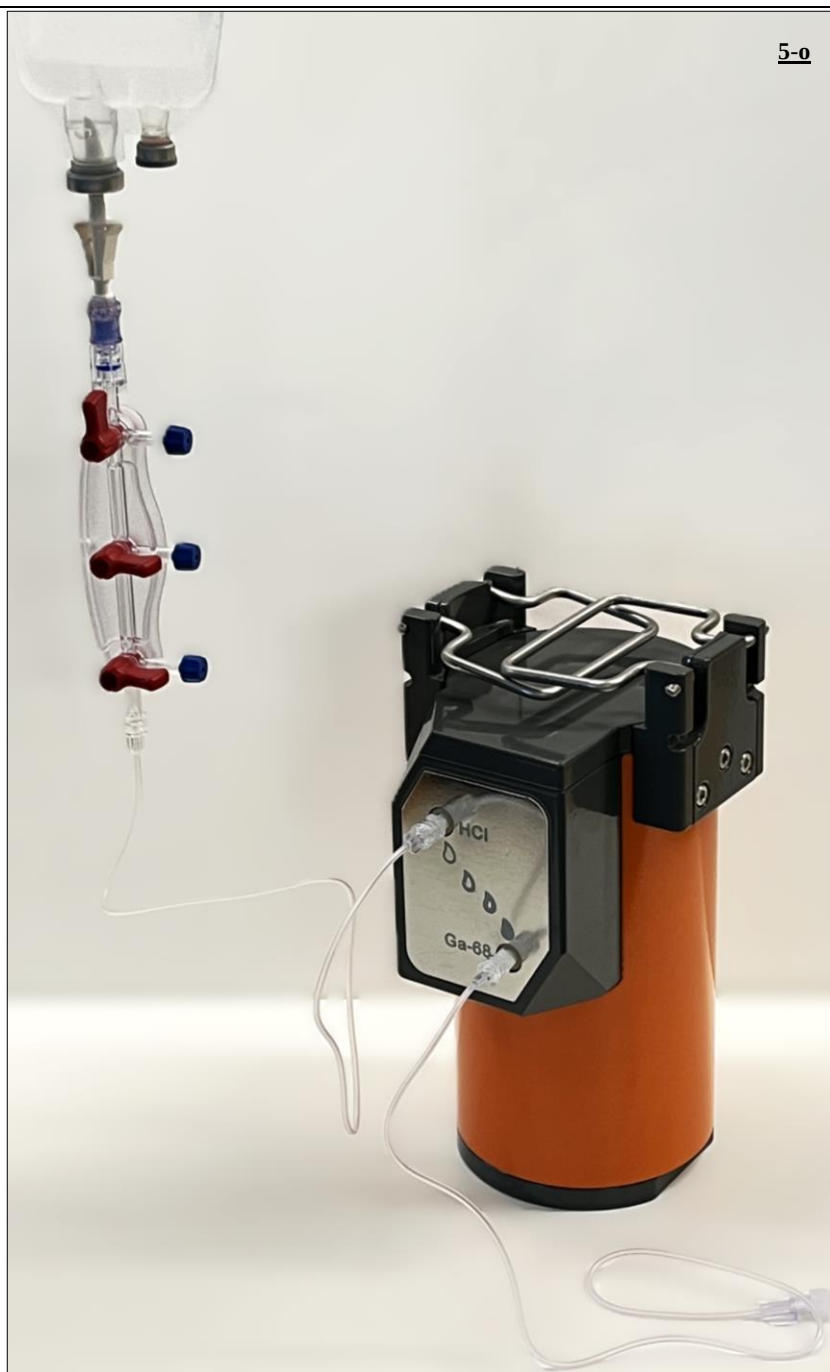
Fig. 24 Slutlig monterad konfiguration av radionuklidgeneratoren med alla tillbehör anslutna.
